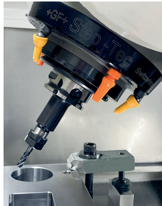
Auch seitlich optimal zugänglich: Die Schwenkachse der Mikron HPM I850U macht's möglich. © GF Machining Solutions
